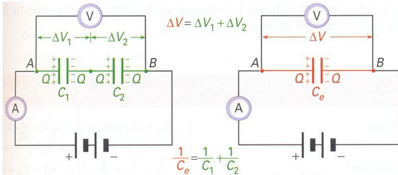
La *capacità equivalente*  $C_{eq}$  dei condensatori in serie, è definita come la capacità del condensatore che, collegato da solo agli stessi terminali A e B, accumula sulle sue armature una carica uguale a quella esistente sulle armature di ciascun condensatore.
