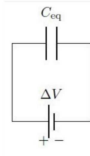
In sintesi:  $C_{eq}$  svolge la stessa funzione dell'intera rete di condensatori.
