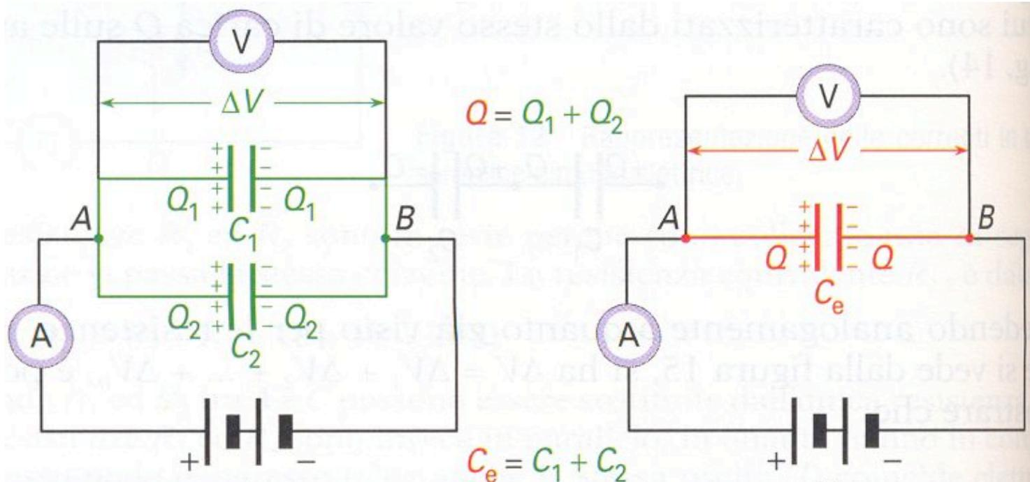
La capacità equivalente  $C_{eq}$  dei condensatori in parallelo è definita come la capacità di un condensatore che è sottoposto alla stessa ddp dei singoli condensatori (oppure, su  $C_{eq}$  si accumula una carica uguale alla somma delle cariche dei singoli condensatori).
