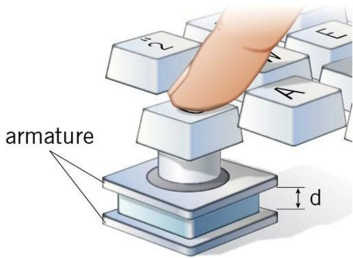
Premendo il tasto, diminuisce  $d$  e la capacità  $C$  aumenta. I circuiti elettronici delle tastiere segnalano al computer che il tasto è stato premuto.
