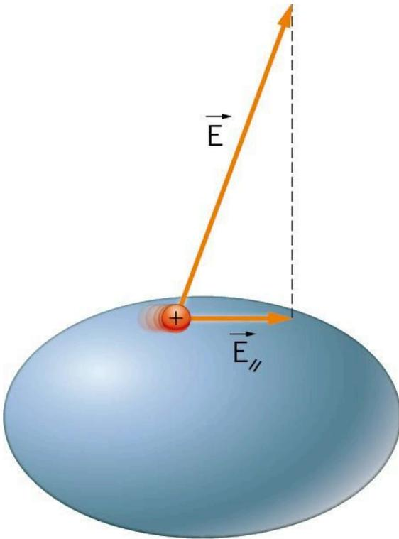
Se  $\mathbf{E}$  non fosse perpendicolare alla superficie, allora la sua componente  $\mathbf{E}_{//}$  darebbe origine a una forza elettrica capace di mettere in movimento le cariche presenti sulla superficie esterna del conduttore.
