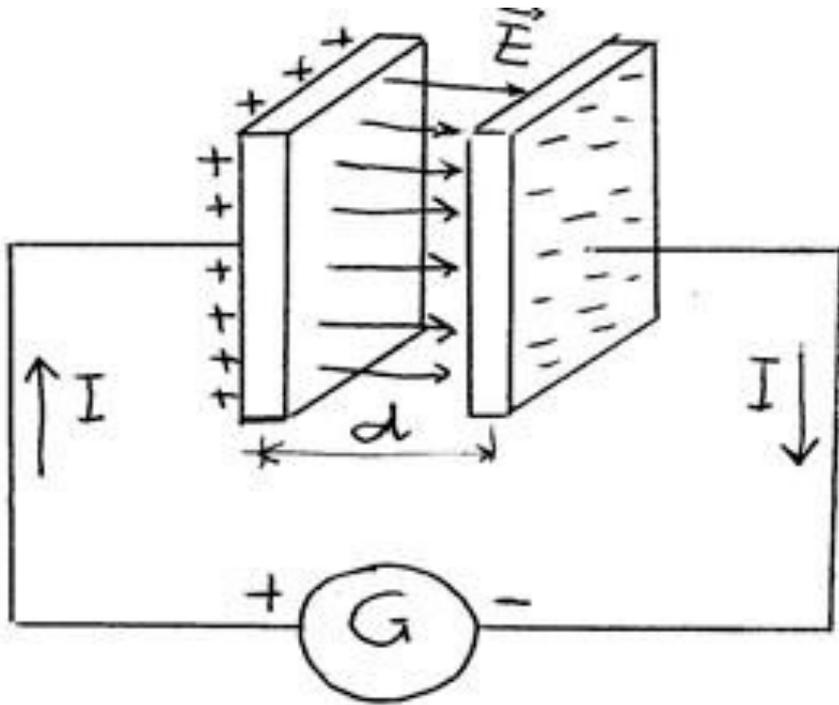
Ogni condensatore è caratterizzato dalla sua capacità e dalla tensione massima che può essere applicata alle sue armature senza danneggiarlo.
