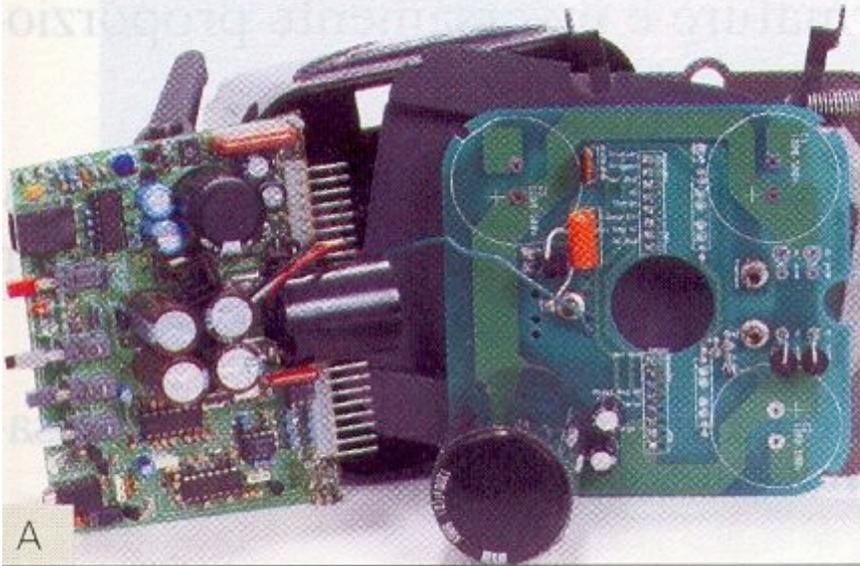
► In un defibrillatore, un condensatore molto più grande accumula l'energia che poi sarà scaricata per regolarizzare il battito cardiaco.
