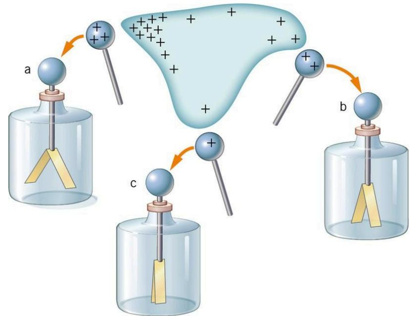
Poiché  $\sigma=Q/S$  può raggiungere valori molto elevati, il campo elettrico in prossimità della punta può diventare molto intenso.
