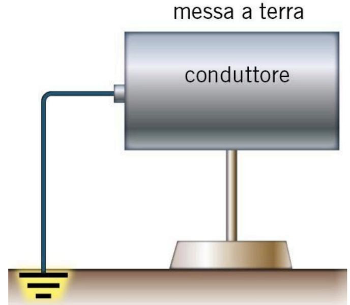
Un conduttore collegato elettricamente con il terreno (messo allo stesso potenziale della Terra) si dice “messo a terra”.
