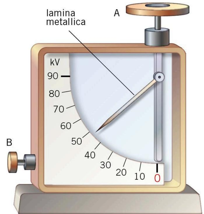
Comportandosi come un condensatore, se vogliamo misurare la ddp tra due punti, basta collegarli ai morsetti A e B. In questo modo, essendo la ddp proporzionale alla carica  $Q$  accumulata sulle armature dell'elettrometro, ( $\Delta V = Q/C$ ), l'indice mobile si sposterà su una scala graduata che misurerà la  $\Delta V$ .
