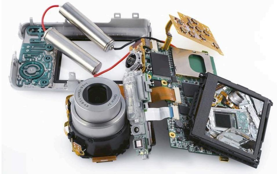
**Macchina fotografica:** Il condensatore accumula energia e mediante una scarica veloce fa funzionare il flash.
