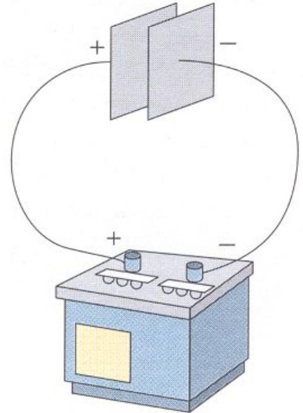
Appena inizia il trasferimento di elettroni, fra le armature si produce un campo elettrico e il generatore deve compiere un lavoro contro la forza del campo per continuare a portare elettroni da un'armatura all'altra. Tale lavoro è compiuto a spese dell'energia chimica immagazzinata nel generatore.
